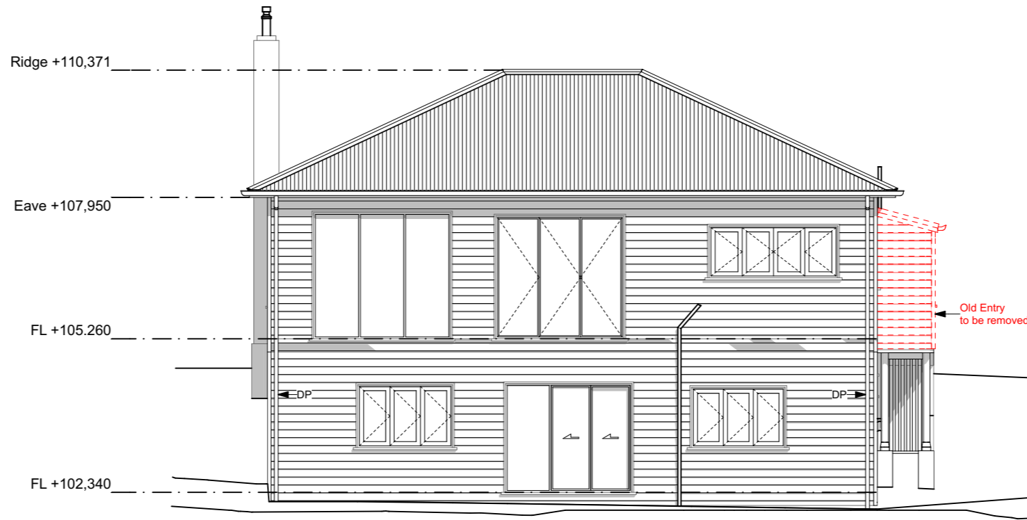
Existing SE Elevation
